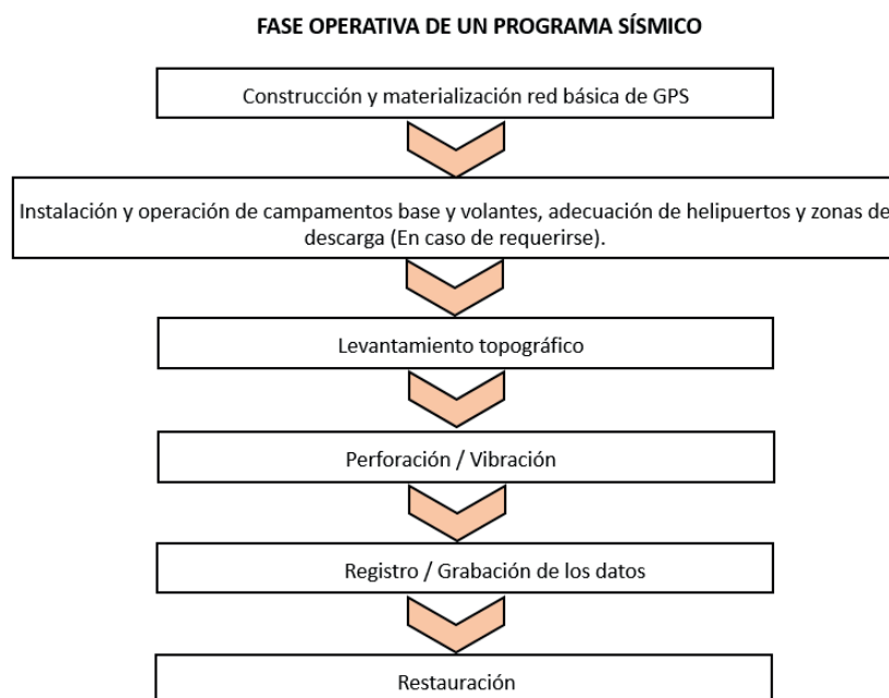
Figura 5.2. Actividades operativas de un programa de adquisición sísmica
