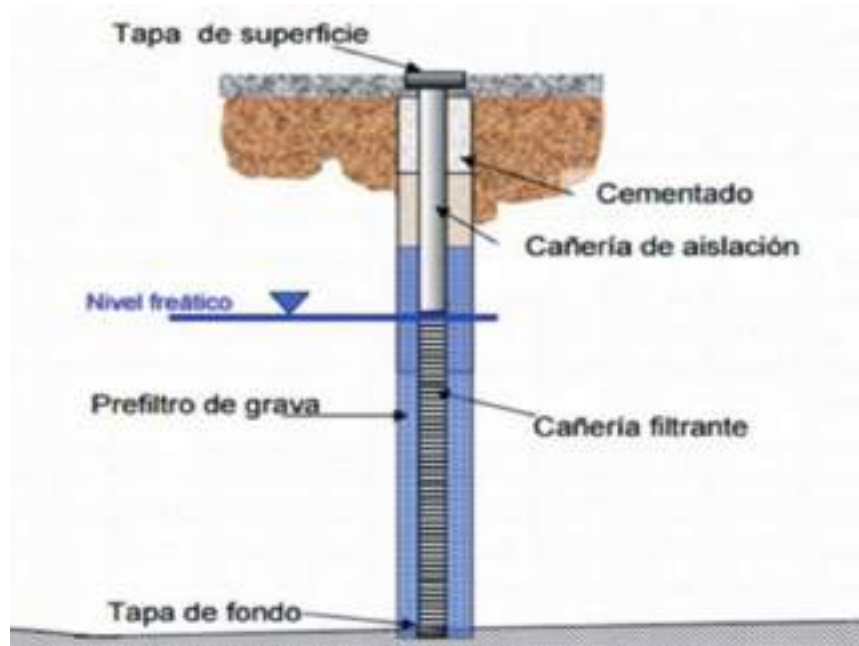
Figura 6.23. Diseño de un piezómetro tipo
