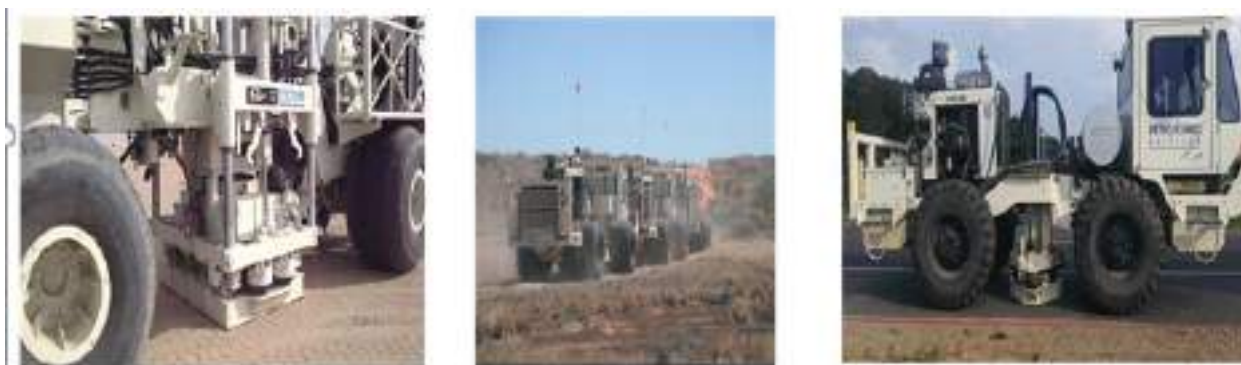
Figura 5.16. Imágenes de un vibro, mostrando la plancha que se posiciona en la superficie (izquierda), flota de vibros (centro) y un vibro en plena actividad (derecha). Nótese que, al poner la plancha en superficie, las llantas del camión quedan suspendidas en el aire
