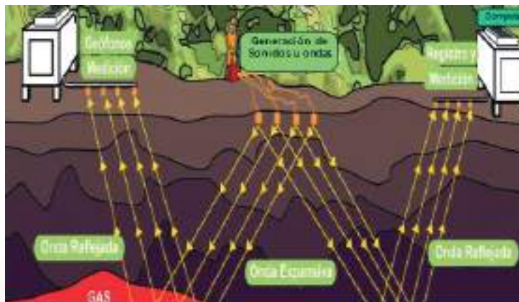
Figura 5.1. Esquema de propagación de ondas sísmicas
