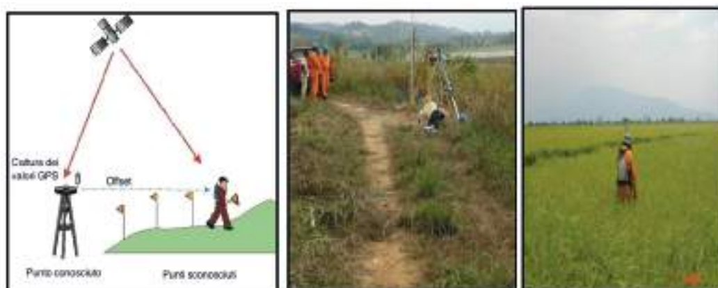
Figura 5.12. Esquema de operación y actividades de campo para el posicionamiento de las estaciones
