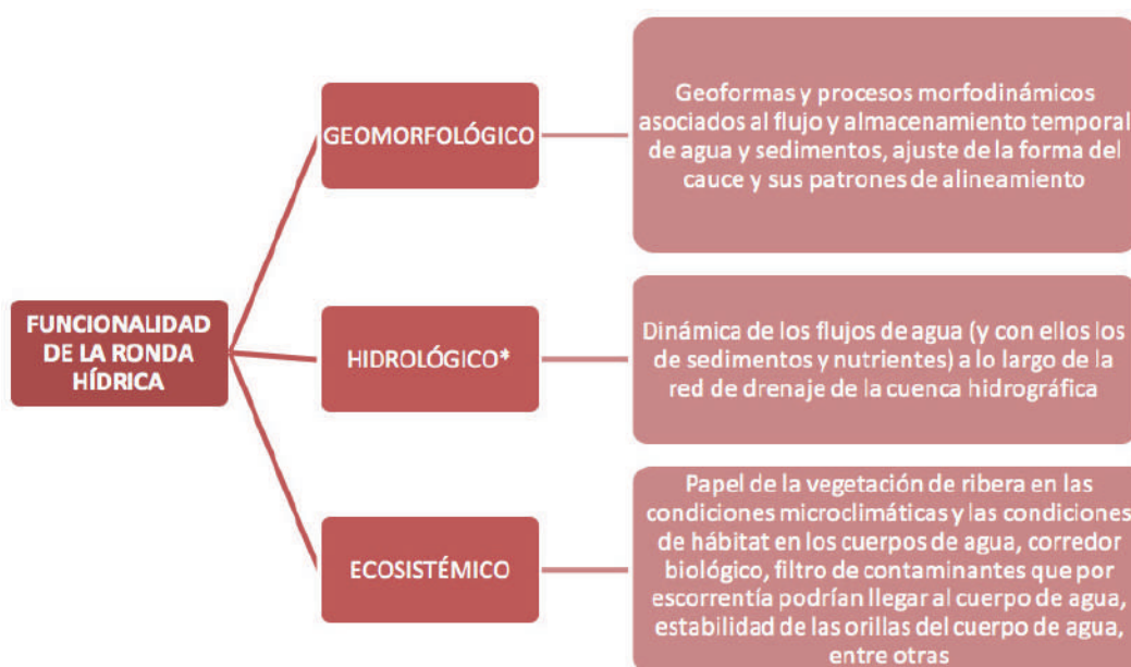
Figura 32. Componentes físico-bióticas mínimas a ser consideradas para definir el límite físico de las rondas hídricas desde su funcionalidad. * El componente denominado “Hidrológico” se entiende en adelante como el componente que resume las funciones hidrológico-hidráulicas de la ronda hídrica.
