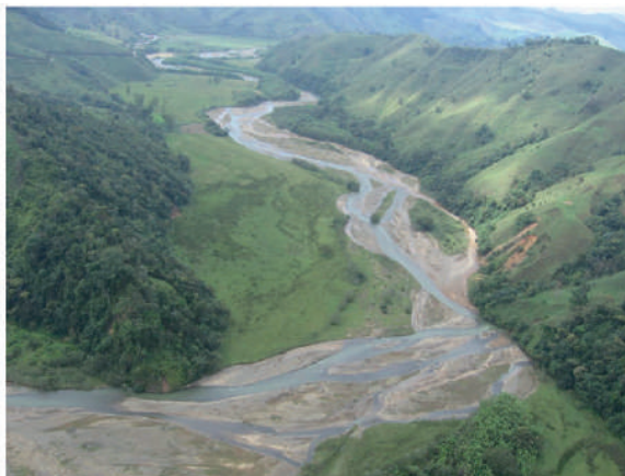
Figura 29. Patrón de río trenzado confinado en corrientes de montaña. Río Herradura, municipio de Abriaquí, Antioquia. Foto tomada por Humberto Caballero Acosta.
