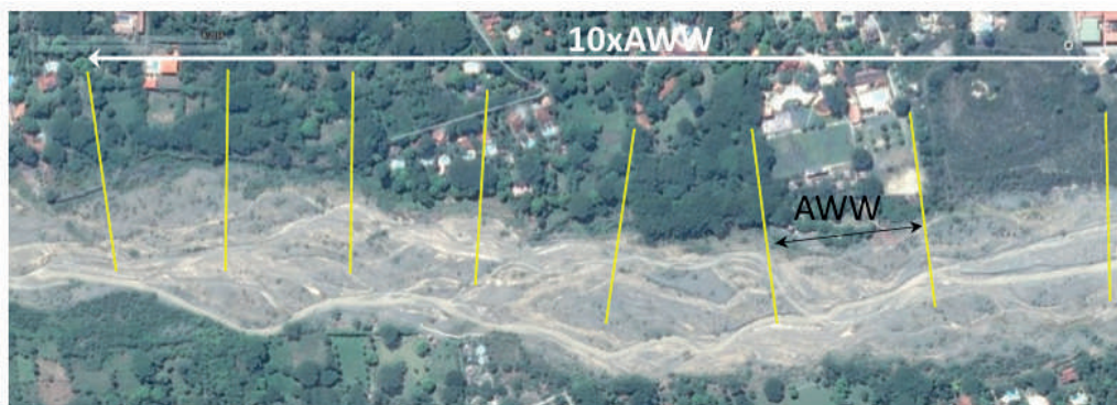
Figura 621. Esquemmatización de la longitud mínima y nivel de detalle para una adecuada caracterización morfológica de ríos Trenzados (Tomada y modificada de Egozi y Ashmore, 2008).
