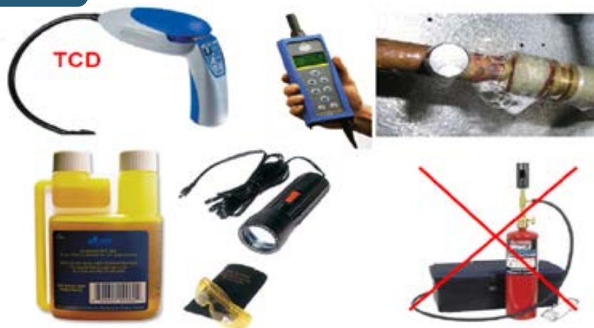
Figura 30 Tecnologías de detección de fugas
