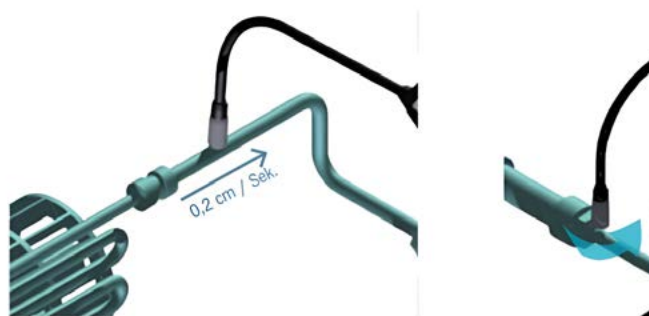
Figura 31 Movimiento del sensor sniffer (TCD)
