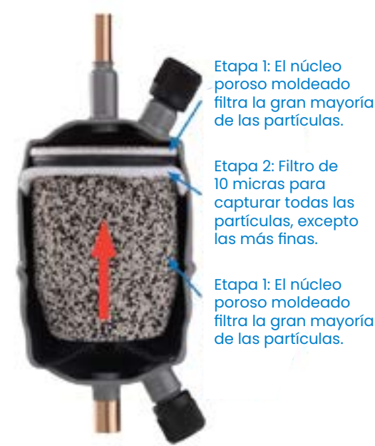
Figura 23 Filtro de alta eficiencia tipo HH o “de quema”
