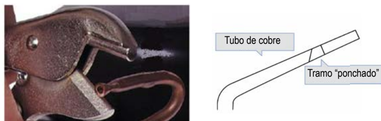
Figura 85 Herramientas y proceso de "ponchado" final de tuberías
