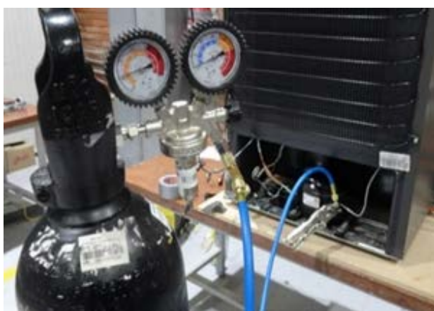
Figura 74 Montaje de prueba de hermeticidad
