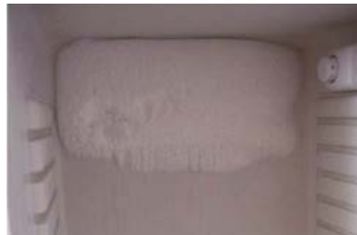
Demasiada escarcha puede ser baja capacidad del compresor, poco refrigerante, fuga o empaque de la puerta defectuoso.
