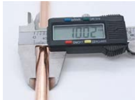
Figura 59 Medición del diámetro del tubo para selección del conector Lokring
