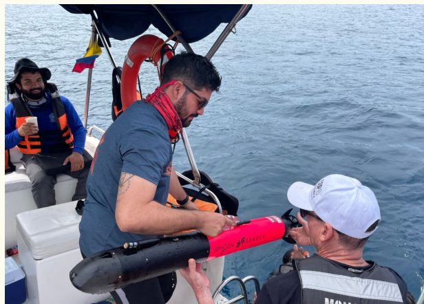
Gráfica 229: Puesta a prueba del AUV (Vehículo Submarino Autónomo)
