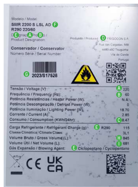
FOTO 43. EJEMPLO PLACA DE IDENTIFICACIÓN TÍPICA PARA EQUIPOS Y SISTEMAS DE REFRIGERACIÓN COMERCIAL AUTOCONTENIDOS CON R-290
