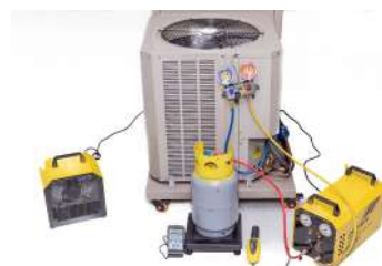
FOTO 120. ESCENARIO DE RECUPERACIÓN DE GASES INFLAMABLES Y CONFIGURACIÓN EJEMPLAR DEL LUGAR DE TRABAJO EN LA EMPRESA, O DEL LUGAR DE INSTALACIÓN
