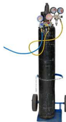
FOTO 131. KITS DE PRUEBA DE PRESIÓN CON NITRÓGENO NSLO
