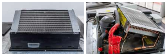
FOTO 8. UNIDAD EVAPORADORA PLUG IN CONDENSADA POR AGUA PARA GABINETES VERTICALES
