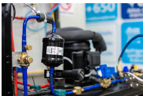
FOTO 129. MANERA CORRECTA DE ABRIR EL CIRCUITO POR CORTE DE FILTRO SECADOR
