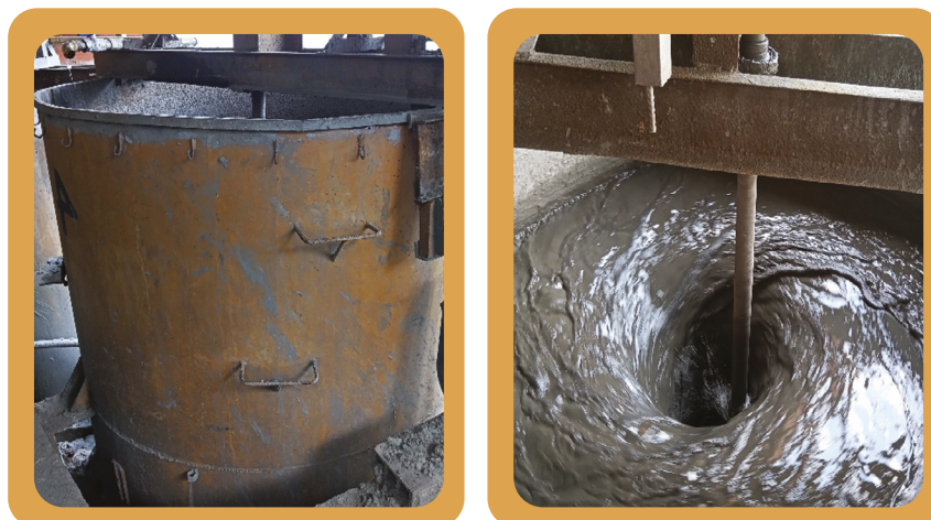
Figura 17. Lixiviación en tanque por agitación mecánica
