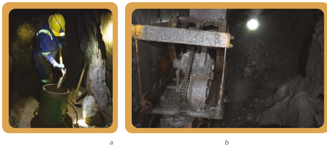
Figura 10. Fotografías de a. un trabajador cargando con pala manual y b. de una pala mecánica operando en el frente de trabajo
