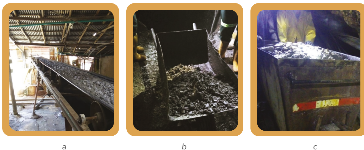
Figura 11. Mineral siendo transportado en a. banda, b. carretilla y c. vagoneta
