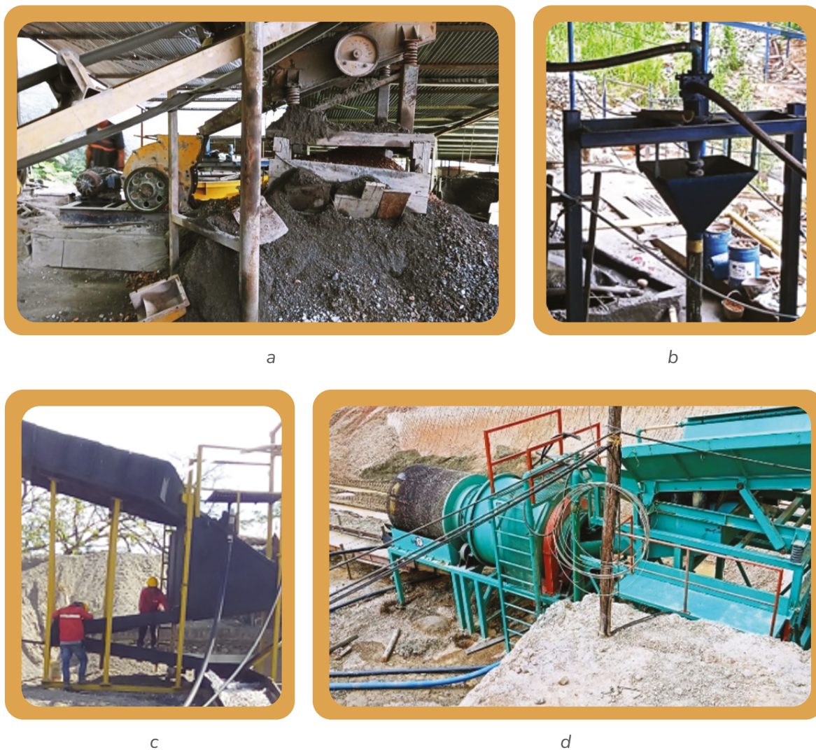
Figura 14. Fotografías de equipos de clasificación de material. a. criba vibratoria, b. hidrociclón, c. sistema de criba y trommel, y d. clasificador aluvial.
