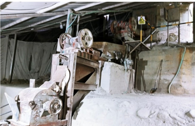
Figura 12. Trituradoras en serie, para reducción de tamaño de material extraído de mina
