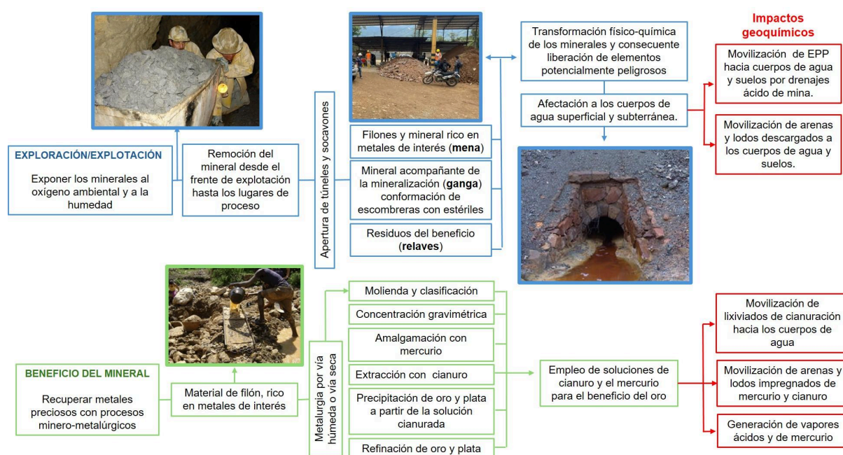
Figura 12. Componente geoquímico de impactos ambientales generados en la minería de oro de filón.
