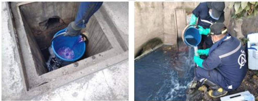
Figura 13. Preparación de muestra compuesta
