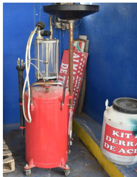
Equipo para la extracción por gravedad de aceite proveniente de VFVU
