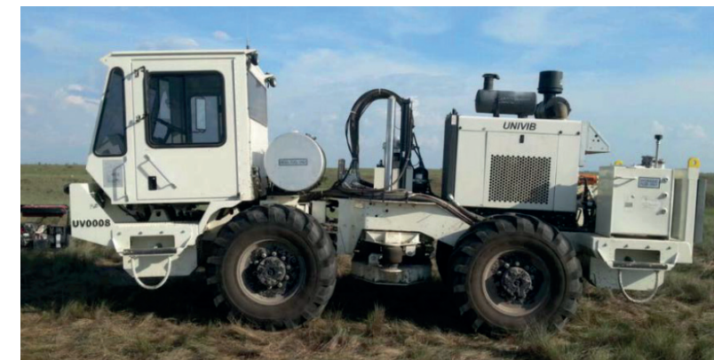
Figura 5.5 Ejemplo de fuente vibratoria
