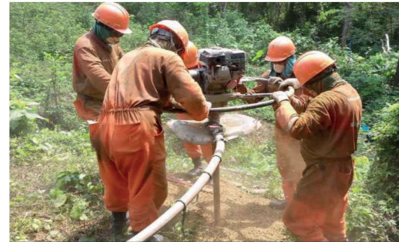
Figura 5.4 Perforación Sísmica con taladros neumáticos
