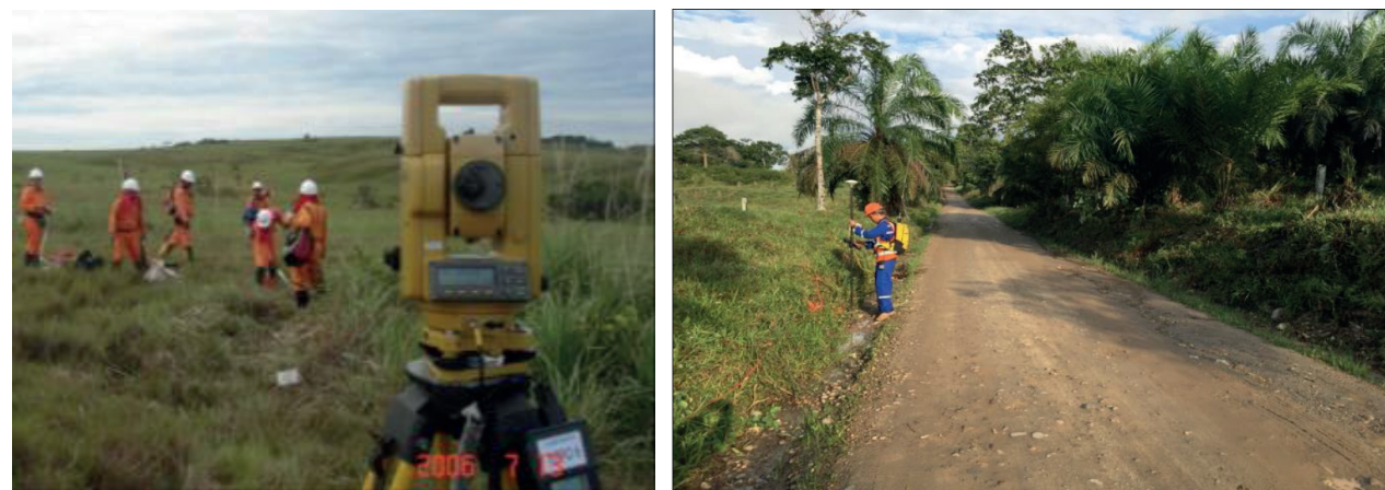
Figura 5.3. Levantamiento topográfico (Estación y Satelital)
