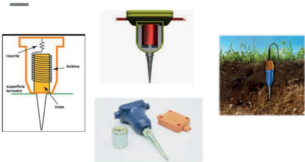
Figura 5.8 Partes de un geófono.
