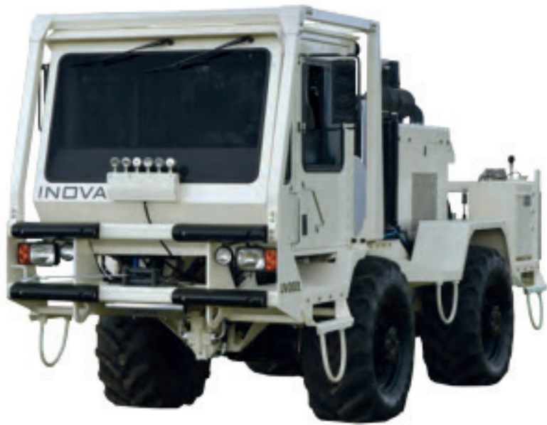
1 UNI VIB, similar al NOMAD 15. Equipos de 9 Toneladas, 6.3 m de largo y 2.13 m de ancho.
