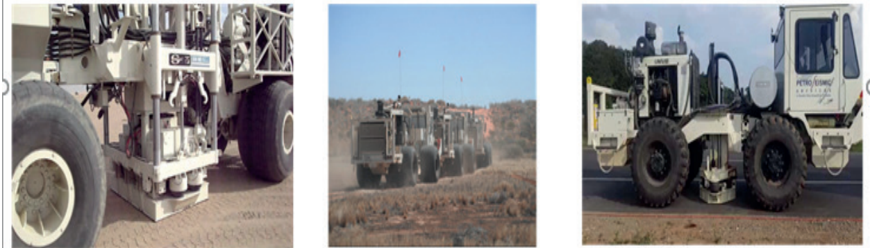
Figura 5.16 Imágenes de un vibro, mostrando la plancha que se posiciona en la superficie (izquierda), flota de vibros (centro) y un vibro en plena actividad (derecha). Nótese que, al poner la plancha en superficie, las llantas del camión quedan suspendidas en el aire
