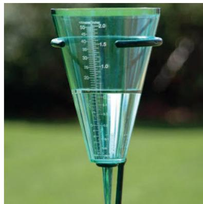
Pluviómetro con reducción de diámetro
