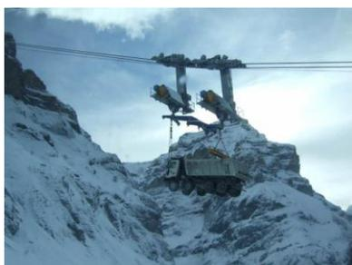
Los cables pueden superar pendientes de más del 100 %. Las góndolas se pueden desenganchar en las estaciones para el cargue y descargue y abordaje y desabordaje de pasajeros. La longitud del cable depende de la potencia de los motores que, por ser eléctricos, dependen de la alimentación que se les pueda dar.
