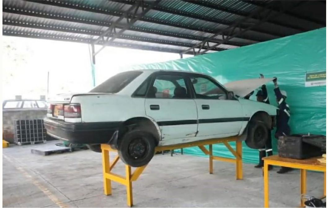
Disposición de un VFVU dentro de las instalaciones destinadas a la extracción de residuos peligrosos, preparado para ser objeto del procedimiento.
