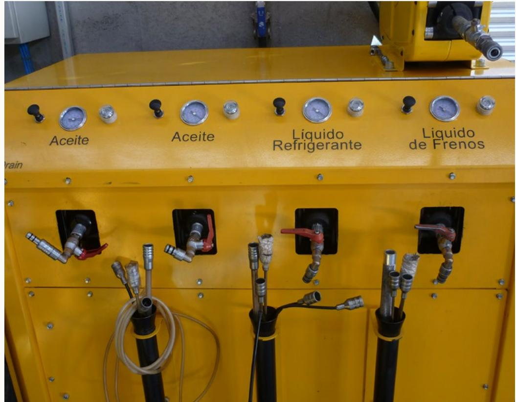
Equipo para la extracción por succión y la medición de los fluidos peligrosos obtenidos de un vehículo a desintegrar
