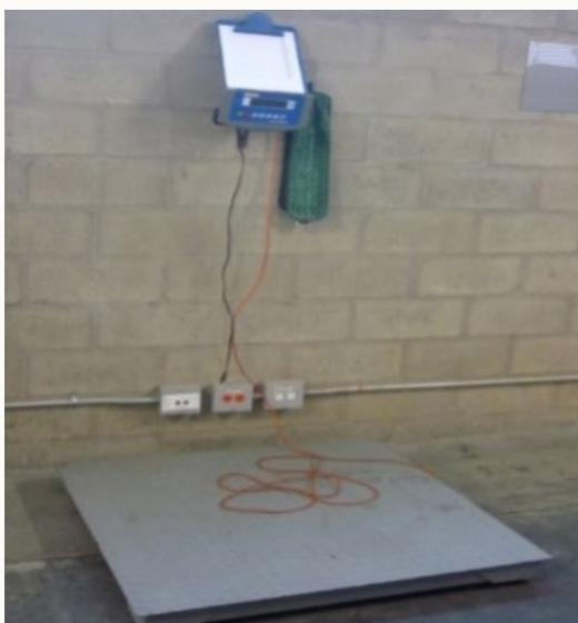
■ Báscula empleada para la medición del peso de los residuos desmontados.
