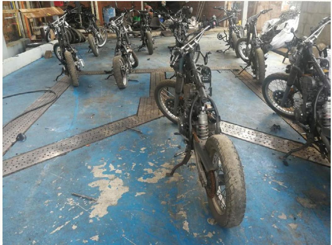
Vista parcial de la zona de desensamble de un CTVFVU que muestra en primer plano motocicletas en proceso de desintegración.
