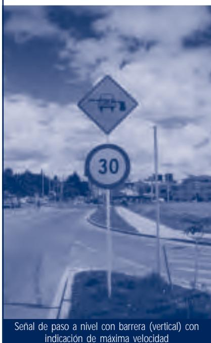
Señal de paso a nivel con barrera (vertical) con indicación de máxima velocidad
