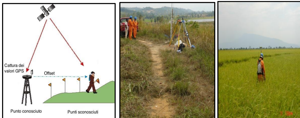
Figura 5.12 Esquema de operación y actividades de campo para el posicionamiento de las estaciones.
