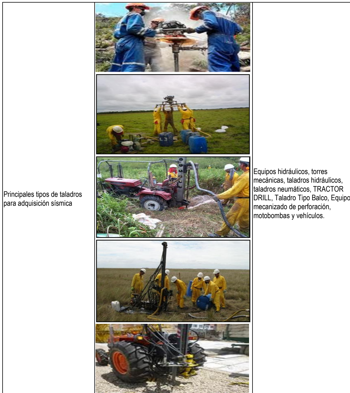
Figura 5.14 Principales tipos de taladros para adquisición sísmica.
