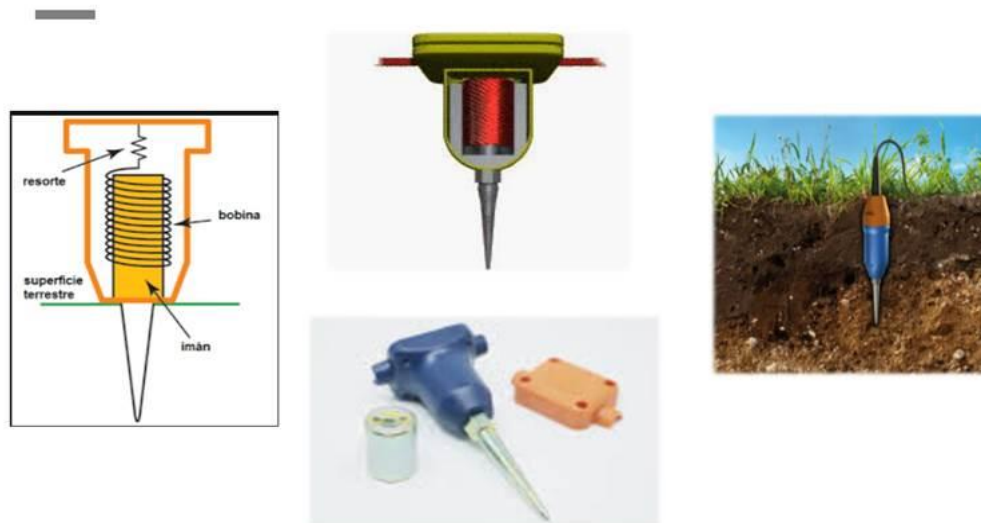
Figura 5.8 Partes de un geófono.
