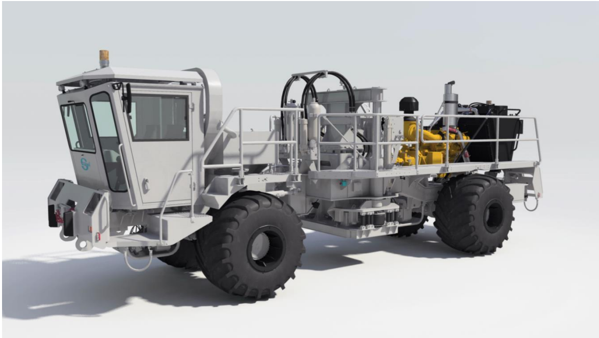
2 Nomad 65, equipo que puede llegar a las 42 toneladas de peso y tiene un largo de 11 m y ancho de 3.50 m.
