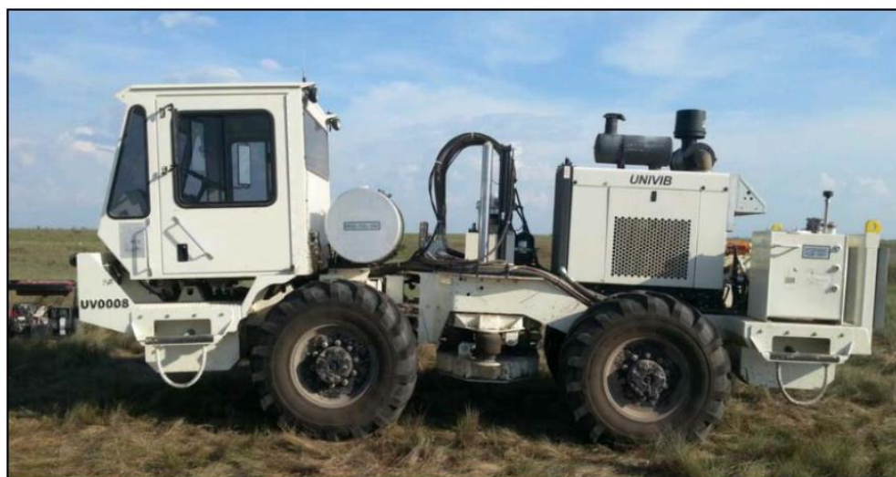
Figura 5.5 Ejemplo de fuente vibratoria.
