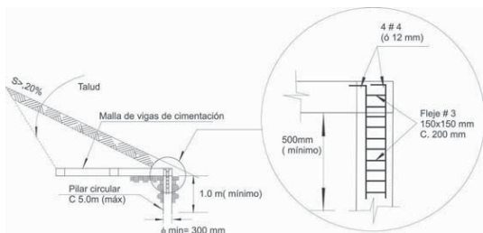
Figura E.2.2-1 — Pilares para estabilizar pendientes mayores del 20%
