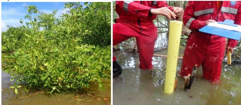
**Fuente: INVEMAR . Figura 2.** A: Individuos de *L. racemosa* en los montículos de sedimentos instalados en la CGSM. B: Instalación de los sensores para medición del hidro período en el sector de calo Clarín Nuevo.
