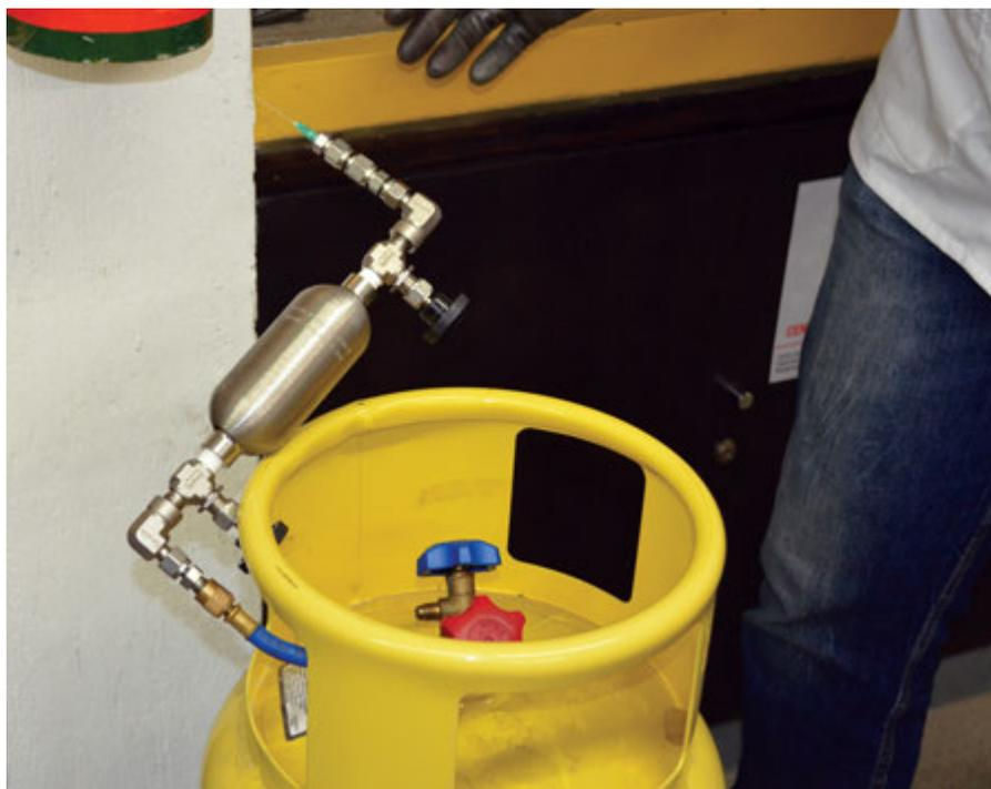
Cierre la válvula del cilindro de muestreo y la válvula del cilindro de muestra, afloje el conector de 1/4 de pulgada y retire el cilindro de muestreo del cilindro de muestra.
