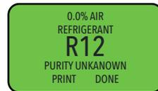
El instrumento también puede identificar y analizar el contenido de componente puro de R134a, R22, HC (hidrocarburos), R404A, R407C y R410A. El análisis realizado por el identificador a refrigerantes de mezclas puras, producirá datos adicionales con respecto a la composición de la muestra de refrigerante.
