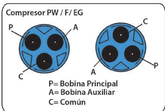
**Figura 13. Prueba de las bobinas del compresor hermético**
