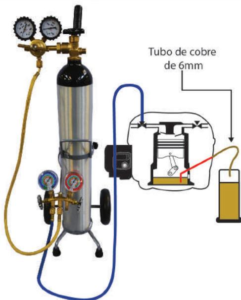
Tubo de cobre de 6mm
