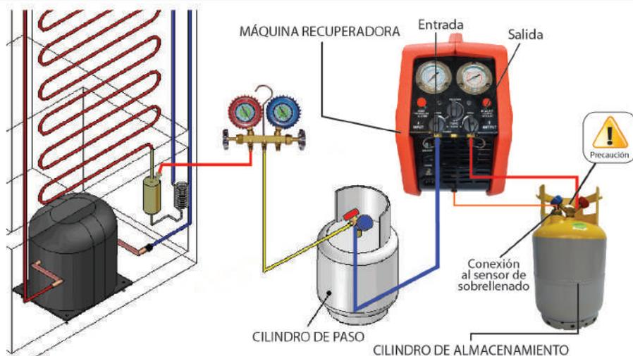
2. Conexión para procedimiento de recuperación por líquido.
