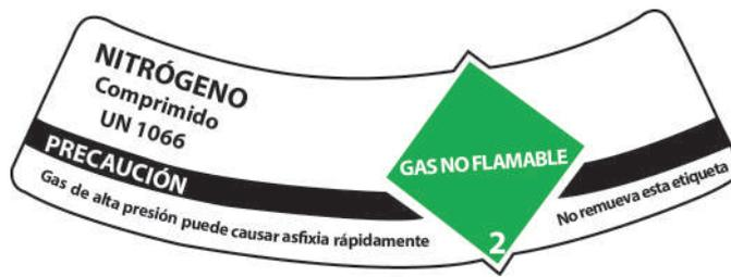
**Figura 74. Información sobre el transporte del nitrógeno**
