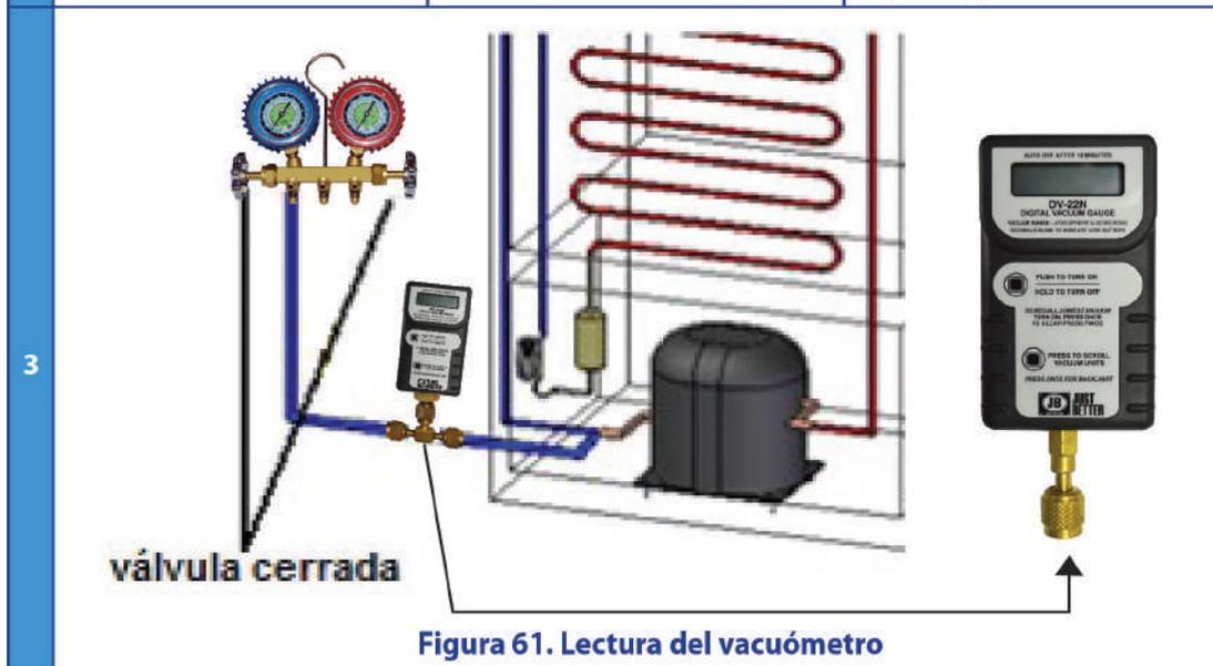
**Nota:** nunca se debe intentar realizar el vacío con el compresor del mismo equipo de refrigeración o acondicionador de aire (auto vacío), pues sólo se logra medio vacío y la humedad nunca se desaloja del equipo, se debe utilizar la máquina de vacío y lograr sosteniendo un vacío:
