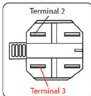
Figura 17. Relé electromecánico tipo "EG y PTC"
