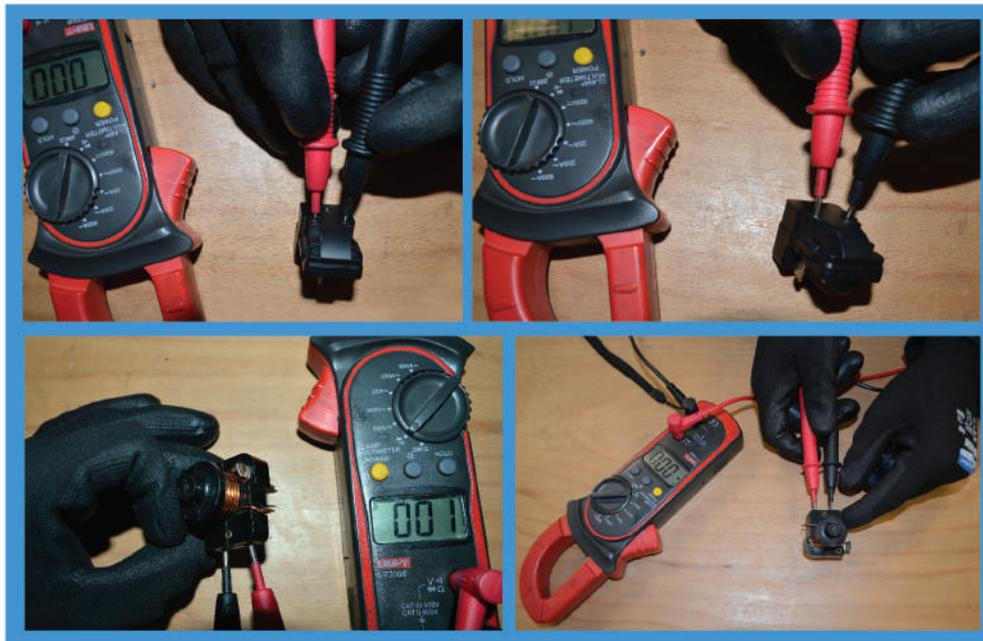
**Figura 18. Prueba eléctrica Relé**
