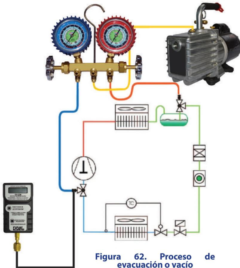
Figura 62. Proceso de evacuación o vacío
