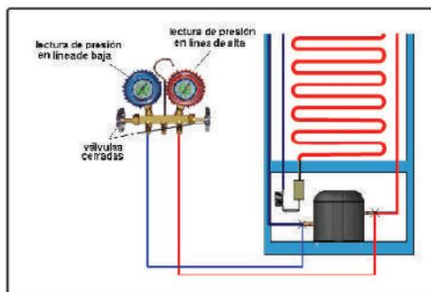
Figura 22. Verificación de presiones y temperaturas de trabajo
