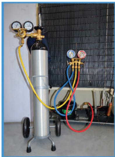
Figura 56. Carga del sistema con nitrógeno.
