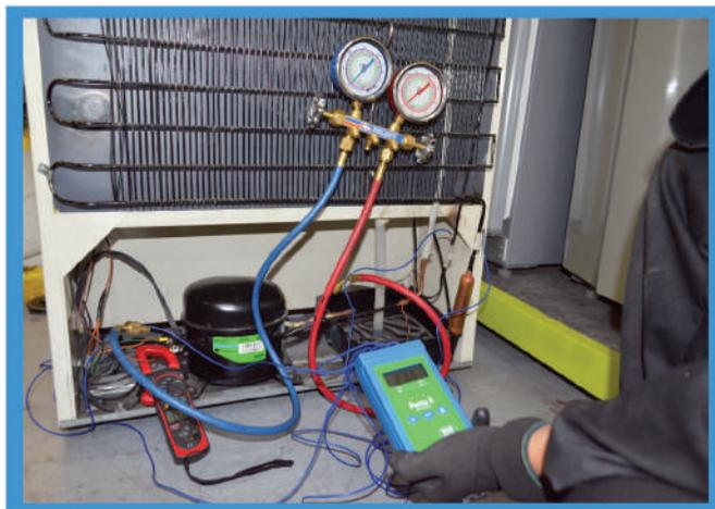
Figura 65. Prueba de estabilización.
