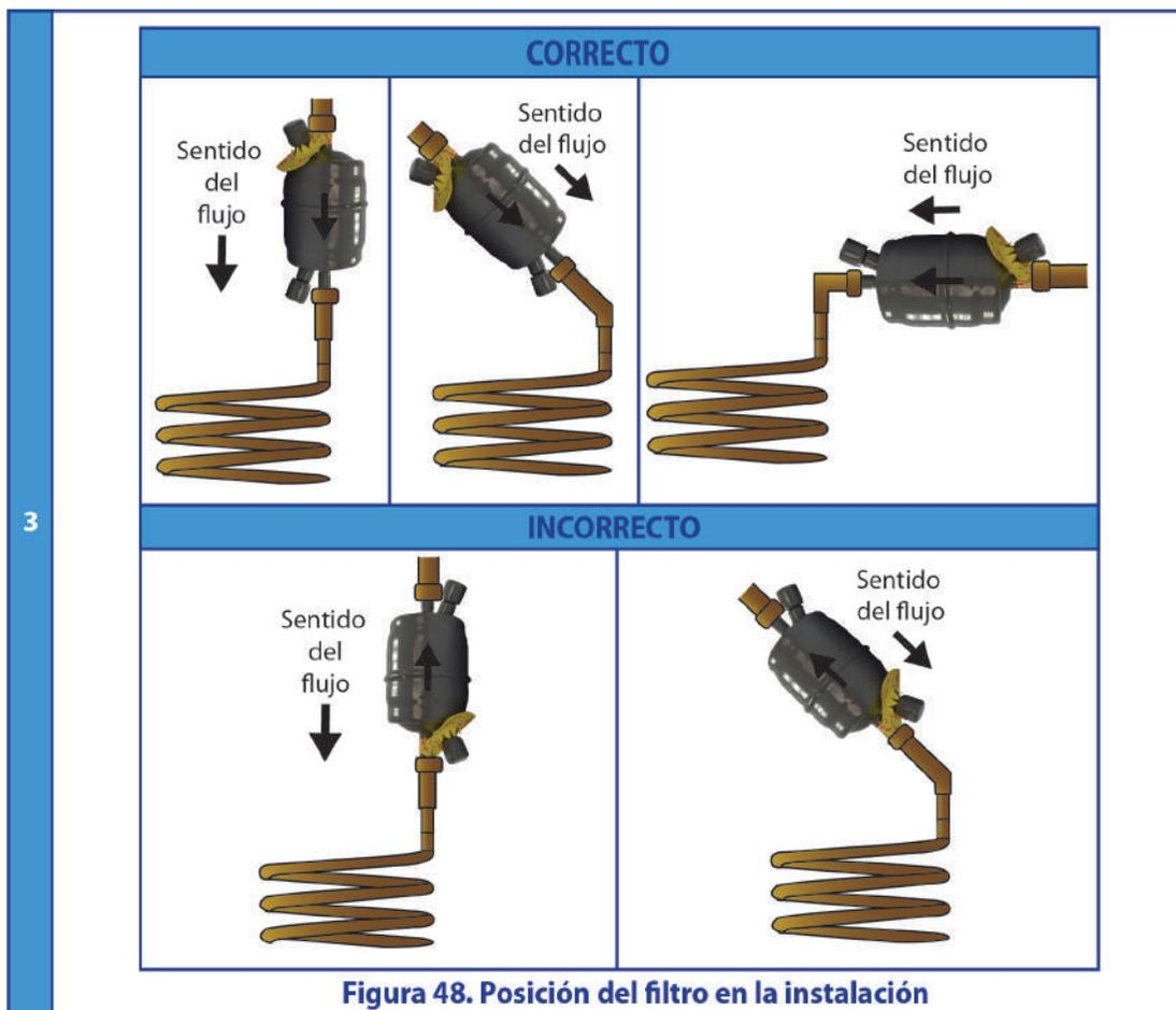
Figura 48. Posición del filtro en la instalación
