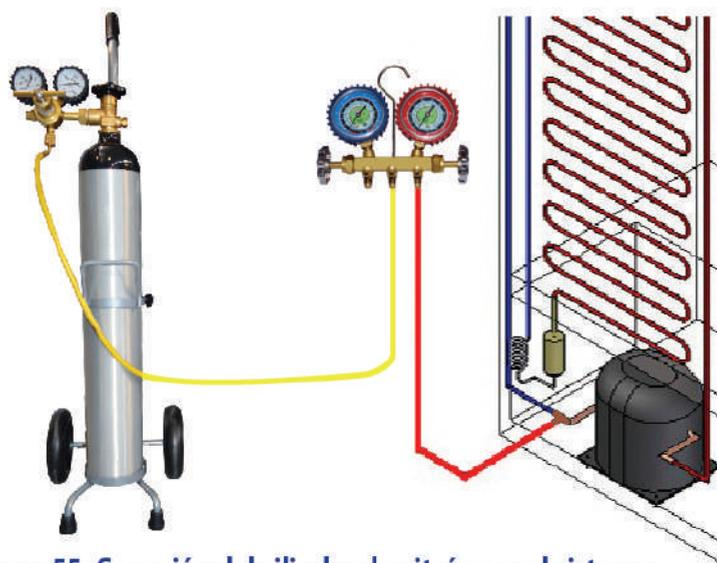
**Figura 55. Conexión del cilindro de nitrógeno al sistema**
