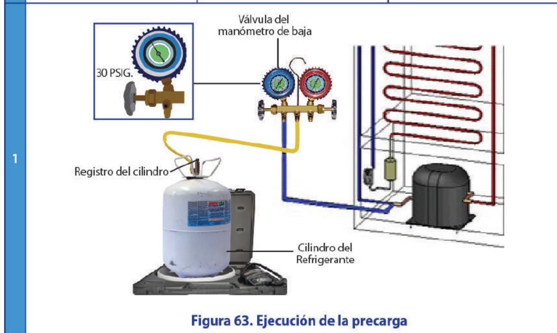
**Figura 63. Ejecución de la precarga**
