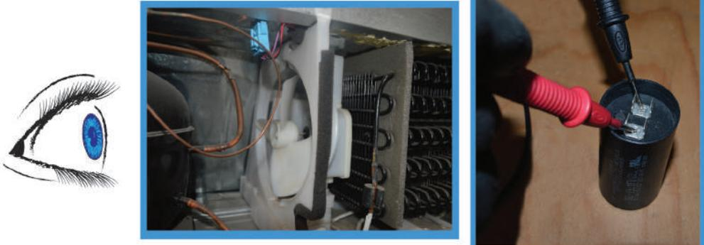
**Figura 19. Verificación de ventilador del condensador y capacitores de marcha y arranque**
