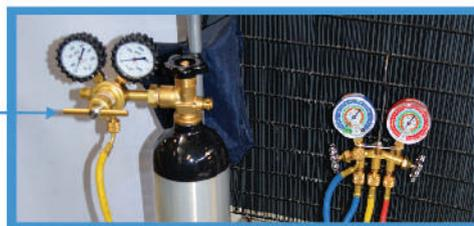
**Figura 41. Conexión del cilindro de nitrógeno al árbol de manómetros**
