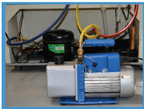
**Figura 58. Conexión de la bomba de vacío al sistema**
