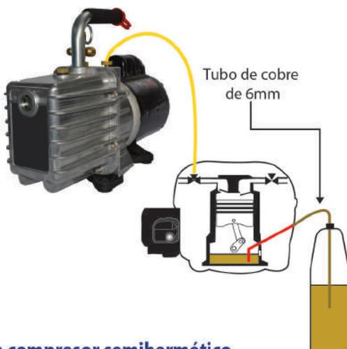
Figura 39. Llenado de aceite en compresor semihermético
