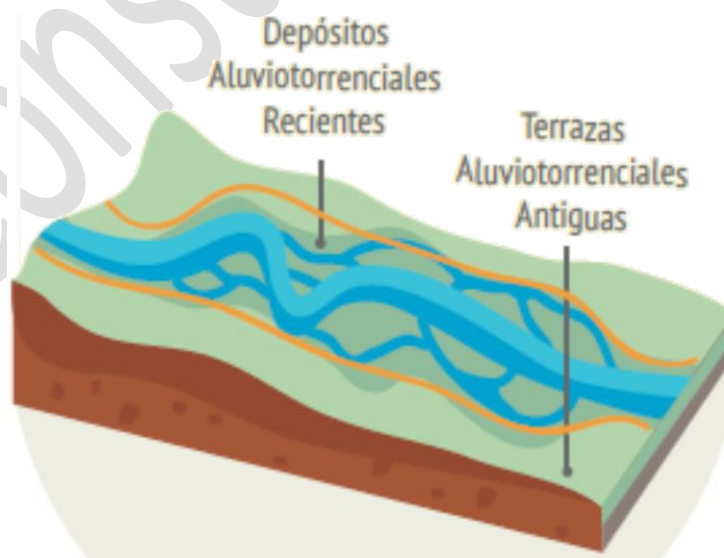
Figura 6-6. Componente geomorfológico (línea naranja) para tramos trenzados en corrientes de montaña.
