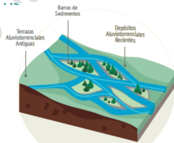
Figura 2-16. Esquematización de un río anastomosado.
