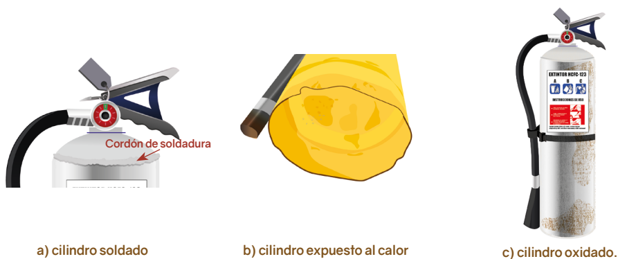
Figura 28. Condiciones de rechazo del extintor durante la inspección inicial
