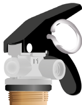
Figura 37. Verificación de los hilos de las roscas de la válvula
