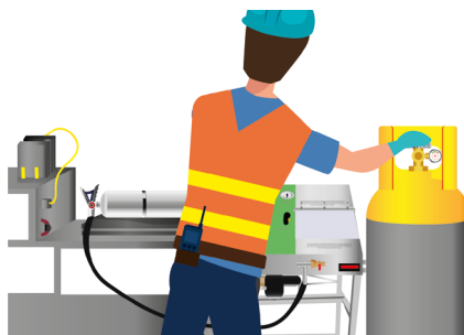
c) Cargar HCFC-123 en el extintor
