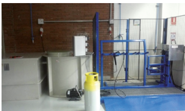
Figura 34. Sistema de lavado interior de cilindros
