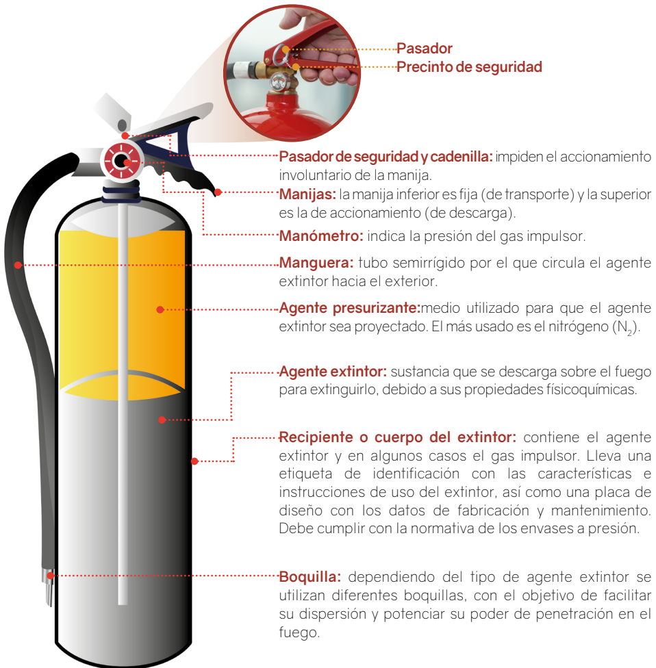
Figura 5. Extintor portátil presurizado y sus partes
