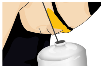
Figura 35. Inspección interna del extintor
