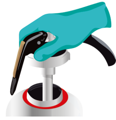
Figura 41. Armado de extintor
