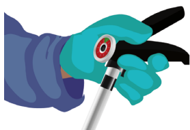
Figura 36. Verificación del estado y operatividad de la manija de transporte y descarga
