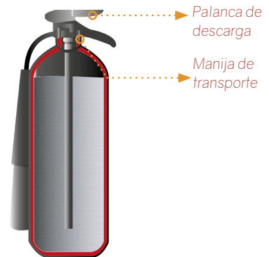
Figura 12. Extintor de dióxido de carbono (CO 2 )
