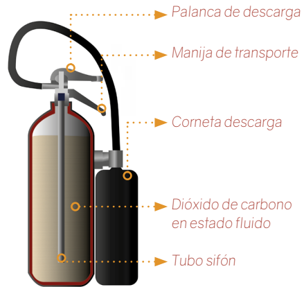
Figura 6. Extintor de presión propia
