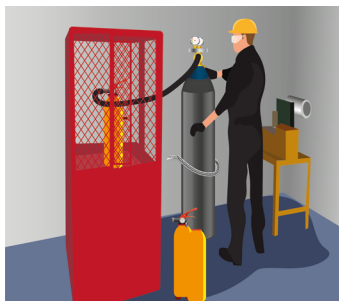
Figura 45. Proceso de presurización con nitrógeno
