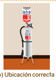
Figura 50. Ubicación de extintores portátiles
