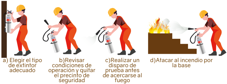
Figura 54. Pasos básicos para la operación de extintores portátiles
