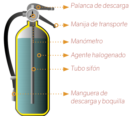
Figura 7. Extintor de presión incorporada
