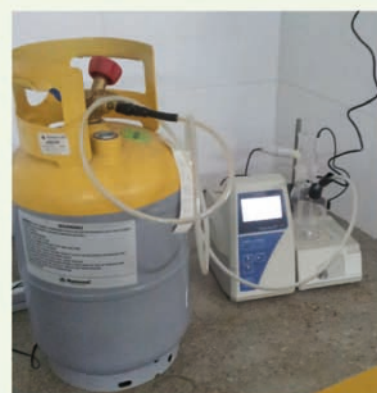
Figura 6. Análisis de humedad en el sistema de titulación Karl Fischer
