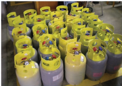
Figura 2. Cilindros retornables de gases refrigerantes
