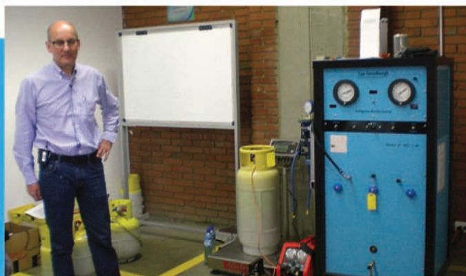
Figura 1. Proceso de regeneración de gases refrigerantes.
