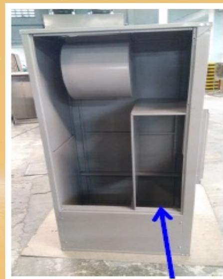
**Figura 10.** Nuevo diseño del retorno en la unidad manejadora. Modelo con elevación interna.
