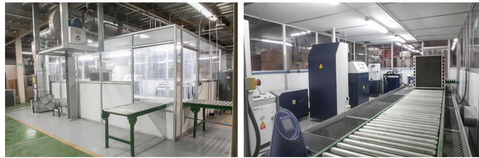
**Figura 2.** Línea de fabricación de AC centralizados split y paquetes con ductos – HC-290.
