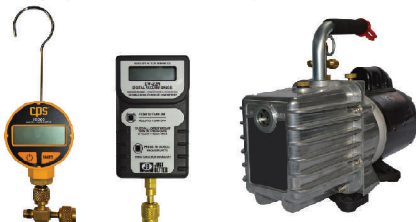
Figura 60. Vacuómetros - medición aceptada, entre 254 a 500 micrones de vacío
