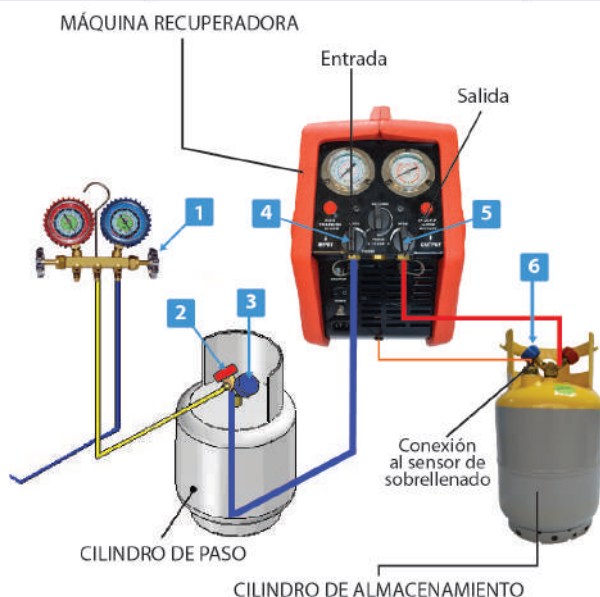
Figura 27. Apertura de válvulas y encendido de máquina recuperadora
