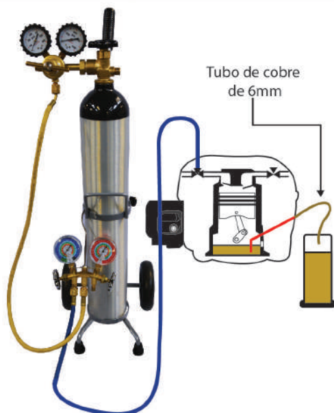
Figura 38. Extracción de aceite del compresor hermético (Izq.) y semihermético (Der.)
