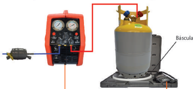
Figura 31. Recuperación con un cilindro sobre la báscula para medir pesos y OFP conectado
