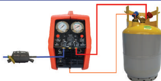
Figura 30. Recuperación con conexión de interruptor de flotación - OFP
