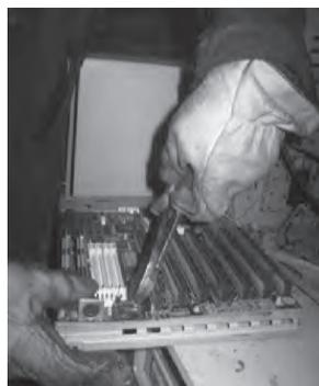
**Ilustración 102:** Separar la pila de respaldo. Foto: MAVDT
