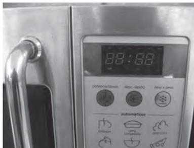
**Ilustración 72:** LCD en un microondas. Foto: MAVDT
