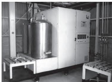
**Ilustración 93:** Modelo de planta pequeña de reciclaje de lámparas fluorescentes.
