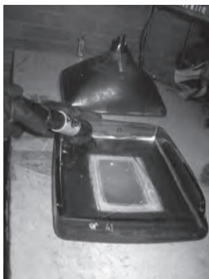
**Ilustración 65:** Aspiración del recubrimiento.
