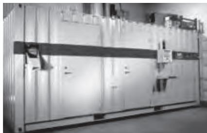
**Ilustración 94:** Modelo de planta mediana de reciclaje de lámparas fluorescentes.
