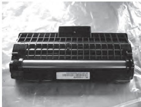
**Ilustración 97:** Tambor fotoconductor montado. Foto: MAVDT
