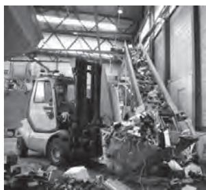
**Ilustración 32:** Equipo de alimentación de un triturador de RAEE.
