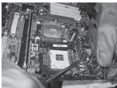
**Ilustración 77:** Desmontar un condensador.
