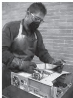
**Ilustración 36:** Desensamble manual de un computador.
