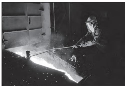
**Ilustración 41:** Fundición de metales. Fuente: [http://www.implats.co.za/im/g\\_impala\\_processing.asp](http://www.implats.co.za/im/g_impala_processing.asp)
