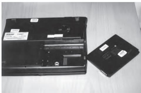
**Ilustración 58:** Acumulador de un portátil (Foto: eag-leitfaden).
