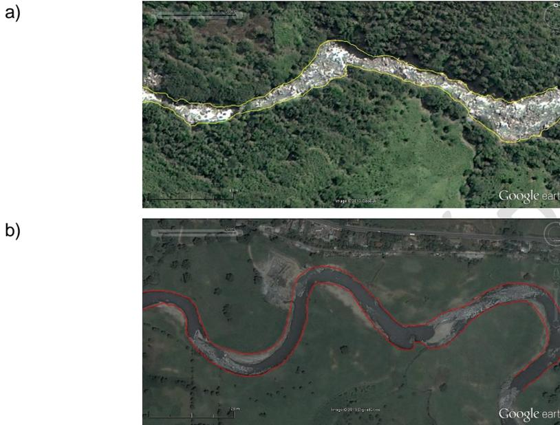
Figura 5-2. Esquemática de la delimitación del ancho de cauce permanente a partir de Imágenes de Satélite. a) Sistema de alta pendiente (>2.5 %). (b) Sistema de planicie (<2.5 %). Fuente: Google Earth.
