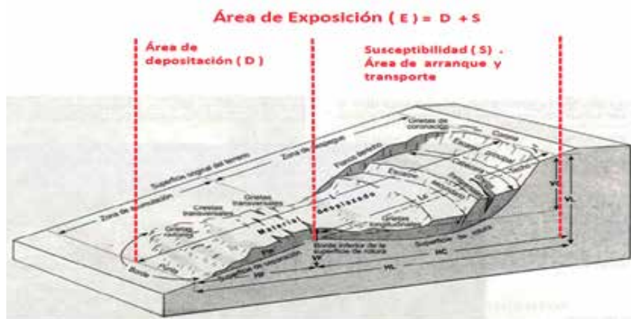
Figura 6. Áreas de manifestación de deslizamientos
