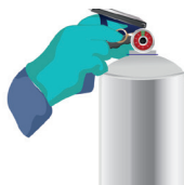
b) Reposición del pasador de seguridad
