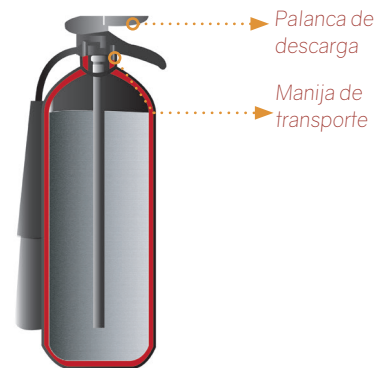
Figura 12. Extintor de dióxido de carbono (CO 2 )
