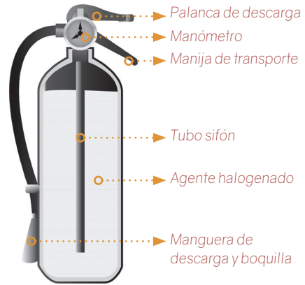
Figura 9. Extintor de agente halogenado Fuente: elaboración propia, a partir de NTC 2885:2009 [5]
