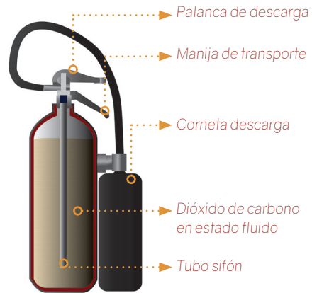
Figura 6. Extintor de presión propia
