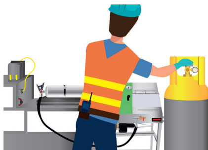
c) Cargar HCFC-123 en el extintor
