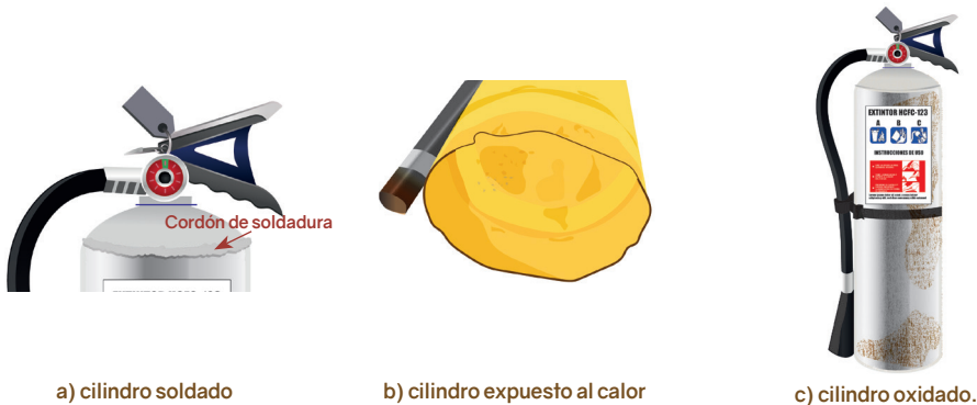
Figura 28. Condiciones de rechazo del extintor durante la inspección inicial
