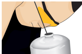
Figura 35. Inspección interna del extintor
