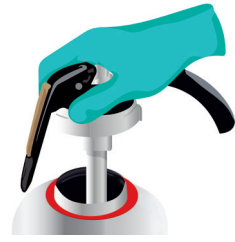
Figura 41. Armado de extintor
