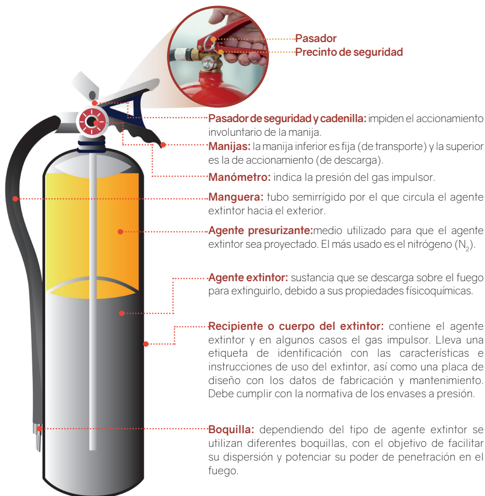
Figura 5. Extintor portátil presurizado y sus partes
