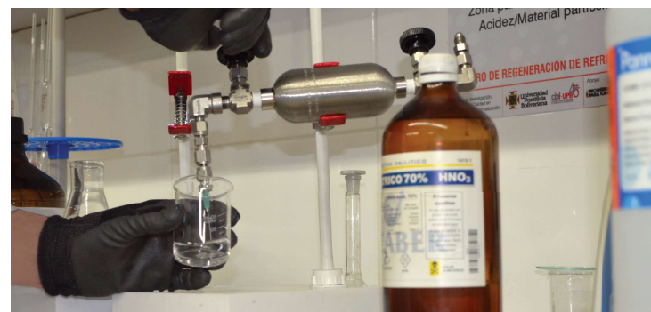
Figura 2. Adición de muestra sobre el Nitrato de Plata metanólico.
