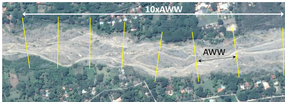
Figura 6-21. Esquemática de la longitud mínima y nivel de detalle para una adecuada caracterización morfológica de ríos Trenzados (Tomada y modificada de Egozi y Ashmore, 2008).
