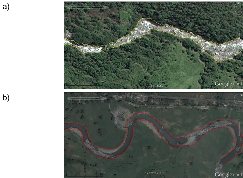
Figura 5-2. Esquematización de la delimitación del ancho de cauce permanente a partir de Imágenes de Satélite. a) Sistema de alta pendiente (>2.5 %). (b) Sistema de planicie (<2.5 %). Fuente: Google Earth.
