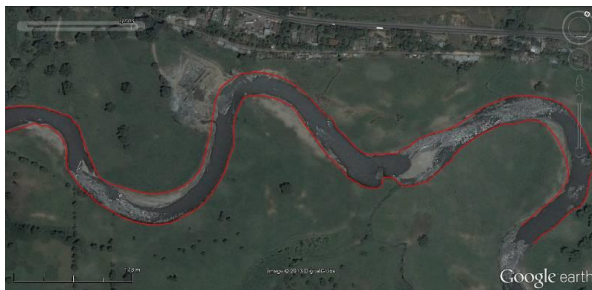
Figura 5-2. Esquematización de la delimitación del ancho de cauce permanente a partir de Imágenes de Satélite. a) Sistema de alta pendiente ( >2.5\% ). (b) Sistema de planicie ( <2.5\% ). Fuente: Google Earth.
