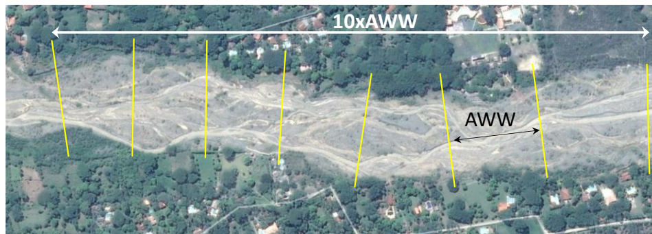
Figura 6-21. Esquematización de la longitud mínima y nivel de detalle para una adecuada caracterización morfológica de ríos Trenzados (Tomada y modificada de Egozi y Ashmore, 2008).
