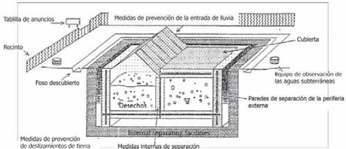
Figura -6 Vertedero de diseño especial (Ministerio del Medio Ambiente, Japón 2007a)
