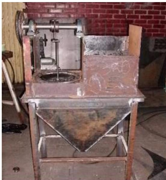
**Concentrador centrífugo:** Los concentradores centrífugos de marca Falcon se utilizan para la concentración de oro libre en el proceso de beneficio; adicionalmente, estos equipos permiten en dichas plantas recuperar mercurio y amalgamas de las colas del proceso de amalgamación.
