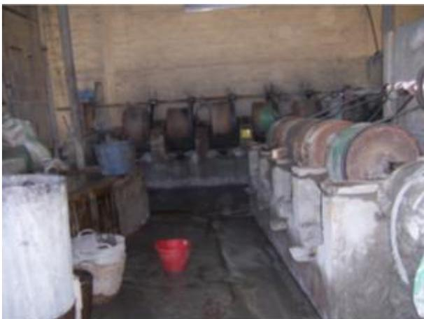
**Amalgamación en molinos:** En la minería de filón, el oro debe ser liberado o expuesto previamente por medio de trituración y la molienda. Muchas veces se aprovecha la operación de molienda para realizar simultáneamente el proceso de amalgamación; en este sistema, el mercurio se vierte dentro del equipo de molienda y la amalgamación del oro se lleva a cabo en circuito abierto. Este tipo de amalgamación se realiza con molinos de bolas, de pisones, de martillo o con molino chileno.
