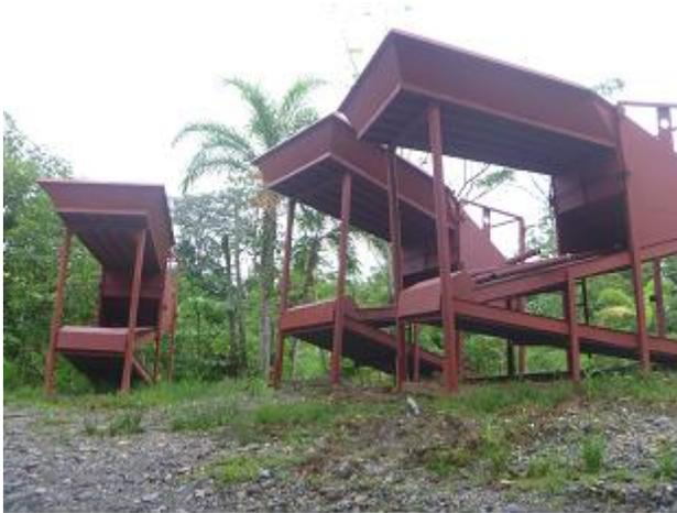
Los canalones trabajan eficientemente con pulpas en relación de 1 parte de mineral por 10 de agua (1:10) y se debe recoger continuamente el concentrado cada vez que se observe saturación del mismo canal. Para el caso de mineral de filón, los canalones usualmente miden entre 1 metro y máximo 6 metros de longitud y entre 40 y 60 centímetros de ancho; el canalón se ubica generalmente después de los molinos y en muy pocas plantas después de las mesas de golpe.
