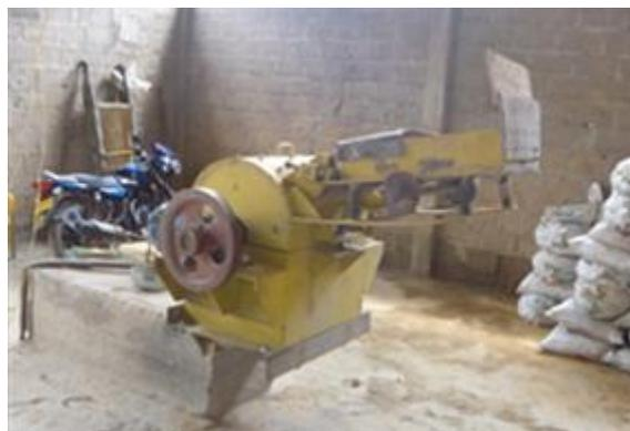
trituradora de mandíbula o alimentadas a un molino de martillos, que las descargan con tamaños menores de 12 milímetros; por lo general la capacidad de trituración de una planta de beneficio en la MAAPE está entre tres y cuatro veces la capacidad de molienda de la misma.
