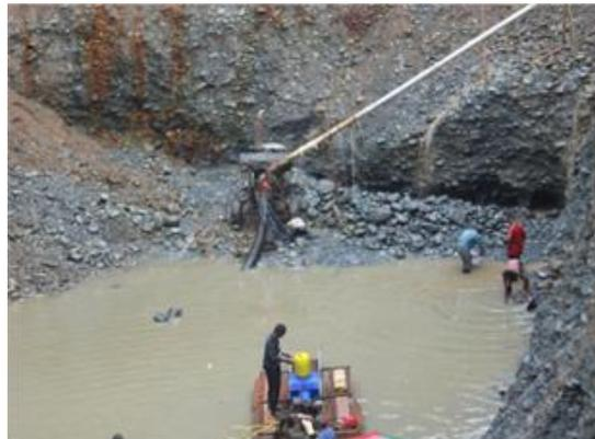
bomba y la tubería hacia el canalón. Dada la fuerte agitación que ocurre durante el transporte, una gran parte del mercurio de la pulpa se pulveriza y se pierde en las colas junto con gránulos de amalgama. En este sistema la recuperación de oro fino es muy baja y sí son altas las pérdidas de mercurio, ya que el mercurio pulverizado y los gránulos de amalgama difícilmente son recuperados en los canalones.
