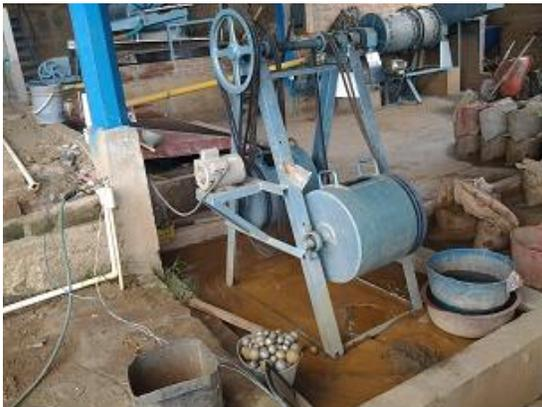
**Amalgamación en tambores amalgamadores**: Los tambores amalgamadores se utilizan frecuentemente tanto en la minería de filón como aluvión. Los tambores amalgamadores son útiles para efectuar una amalgamación controlada y eficiente en circuito cerrado, reduciendo notoriamente las pérdidas de mercurio.
