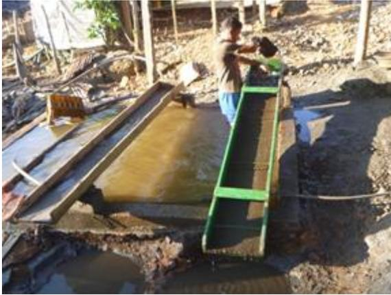
**Canalón:** Este elemento de concentración de bajo costo, de fácil operación y fabricación en la misma planta de beneficio, permite a la minería artesanal y de pequeña escala beneficiar casi todo el oro extraído en sus entables. El canalón (canelón, canaleta o tranque), está formado por un canal fabricado en madera, lámina o cemento y recubierto por textiles, encima de ellos se coloca una malla expandida o unos rifles, que permiten realizar golpes de agua y concentrar los minerales.
