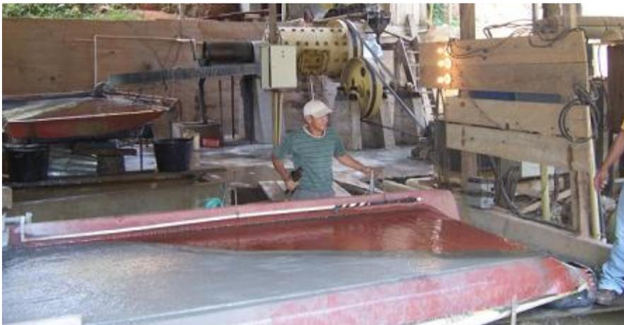
tratar en procesos de amalgamación; la eficiencia del equipo muestra recuperaciones entre el 60% y el 80% y hasta el 95% del oro libre cuando está encadenada a otra mesa.
