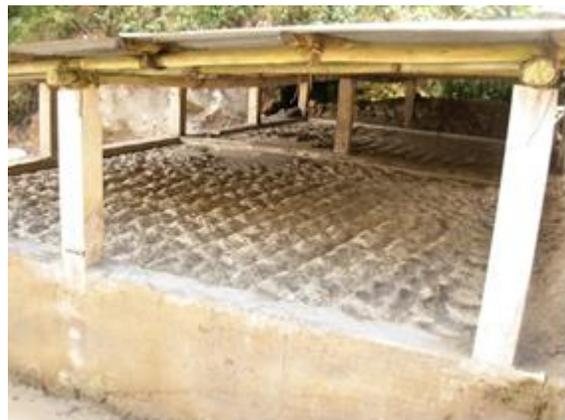
contaminados con mercurio en los circuitos semi cerrados son acumulados en tanques y piscinas de sedimentación; luego estos materiales se llevan al proceso de cianuración. Cuando los minerales son fáciles de cianurar, la cianuración se realiza por el sistema de percolación y cuando presentan grados de dificultad en su tratamiento, entonces son sometidos a cianuración por agitación.
