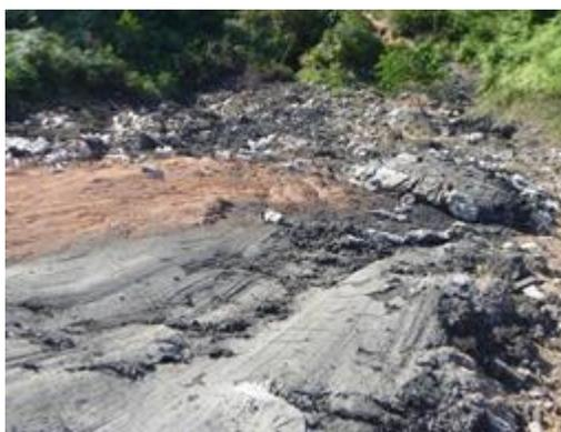
donde se almacenan temporalmente; cuando los pozos empiezan a colmatarse, los mineros los desocupan y las arenas se depositan en pilas o montones al aire libre; los lodos que van junto con las arenas por lo general no alcanzan a depositarse en los desarenadores y muchos de ellos se escapan a las corrientes de agua.
