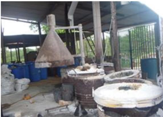
Los precipitados secos son pasados a fundición y refinación del oro al igual que las esponjas obtenidas de la destilación. Para fundir se agregan las llamadas cargas fundentes, que están compuestas por bórax, carbonato de sodio y nitrato de potasio. La mezcla obtenida se introduce en un horno durante y 1 ½ a 2 horas y a una temperatura mínima de 1.200 °C, lo cual produce la fundición del material; en este punto se vierte en un molde la parte metálica (oro +
