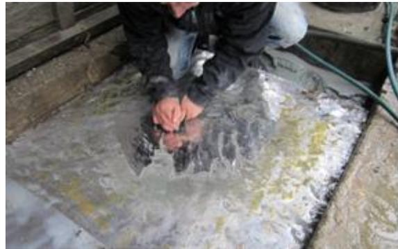
Las placas también deben ser limpiadas varias veces al día y ser reacondicionadas para su reutilización, lo que aumenta los costos de operación. Generalmente la eficiencia de las placas amalgamadoras se ve afectada por la presencia de óxidos de hierro en el mineral y por la contaminación del mercurio con diversas sustancias, que reducen notoriamente la eficiencia de la amalgamación.
