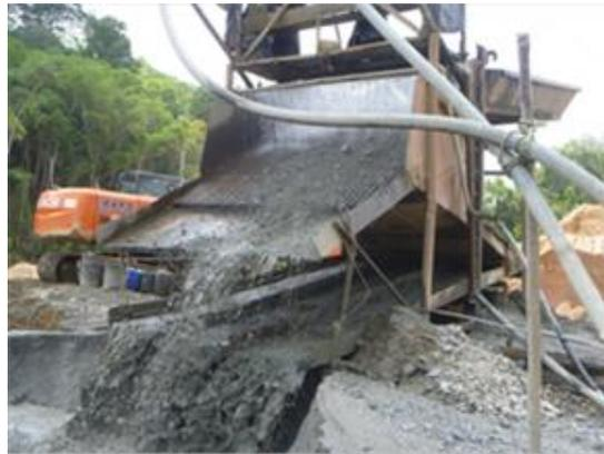
En las pequeñas explotaciones de oro aluvial (barequeo, monitoreo con bombas y dragas de menos de 4”), el oro es separado mediante el uso de bateas y canalones que no tienen más de 3 metros de longitud; finalmente todo el material se concentra en la batea y el oro libre obtenido se destina para la venta.
