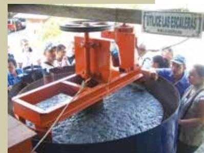
Celda de flotación construida con la asesoría del GMP-2
