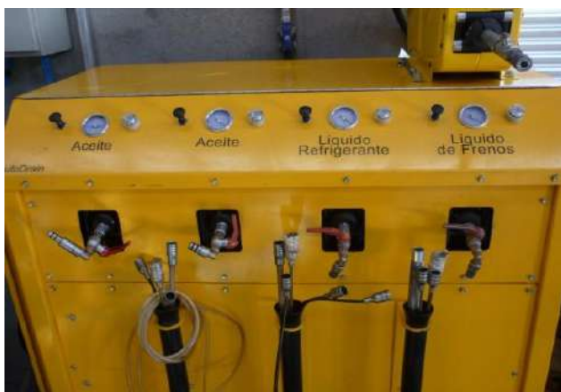
Equipo para la extracción por succión y la medición de los fluidos peligrosos obtenidos de un vehículo a desintegrar
