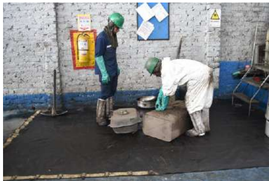
Detalle de la extracción de combustible del tanque
