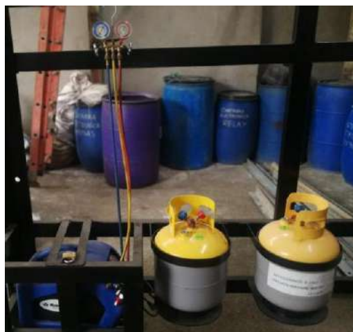
Equipo para la extracción de gases del sistema de aire acondicionado
