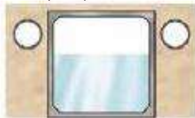
Figura 43: Alternativa de adaptación de un box hidráulico agregando dos alcantarillas para paso de fauna seco.
