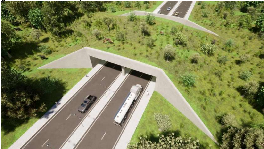
Figura 16: Estructura tipo - Ecoducto
