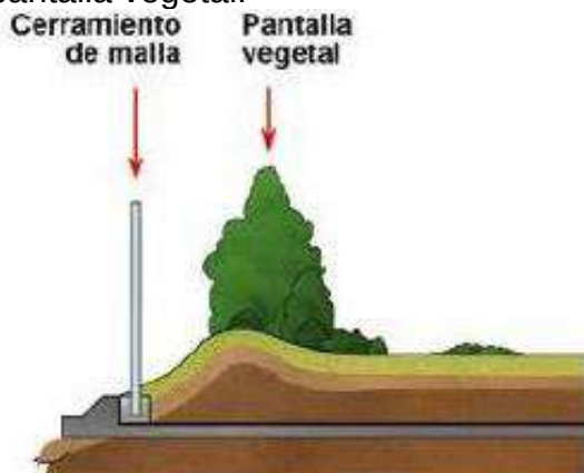
Figura 65: Combinación de barrera y pantalla vegetal.
