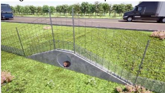
Figura 63: Estructura tipo – Barrera
